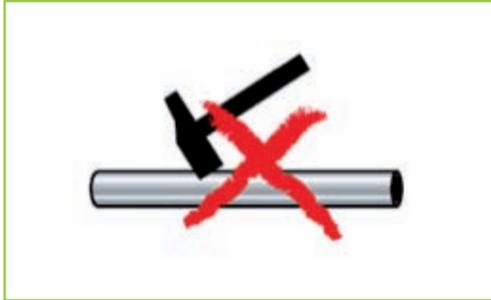
Les composants des systèmes de tuyauterie en plastique doivent être protégés contre les chocs, les chutes, les coups ou tout autre dégât mécanique pendant leur transport et leur installation.
